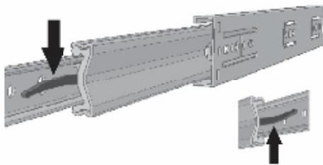
Abra a corredeira até o limite máximo e desconecte o trilho menor, pressionando a parte central da alavanca.
