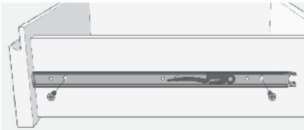
Fixe o trilho retirado na lateral de gaveta, usando o furo de regulagem.
